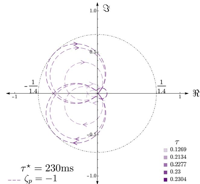
SUFFICIENT FREQUENCY DOMAIN CRITERION CAN BE CHECKED GRAPHICALLY FOR LOWER ORDER SYSTEMS → DELAY MARGIN CAN BE DERIVED USING NYQUIST PLOT & CIRCLE CRITERION AS
